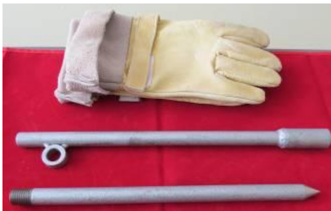
Рис.2 Анкер (якорь-лом с проушиной, в транспортном положении)
