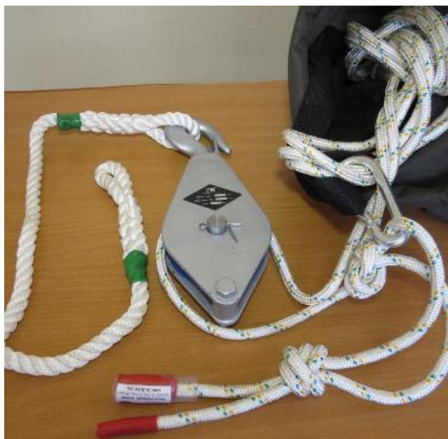
рис.1 Бесконечный канат, с поводком
