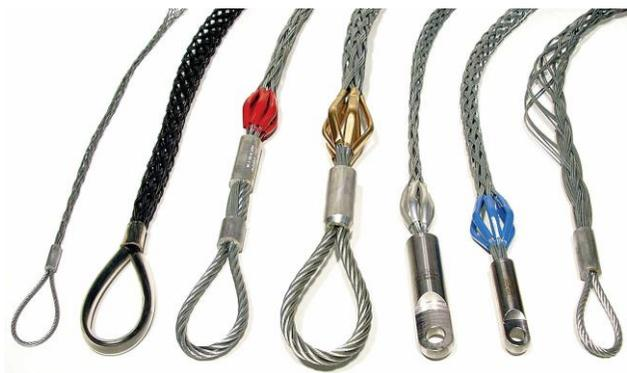
Чулки для жгута СИП применяется для соединения троса - лидер (каната) с изолированным проводом в процессе раскатывания СИП по роликам. Чулки **ЧМ1** либо **ЧМ2** изготовлены из пластиковых нитей и позволяют выполнять монтаж ВЛИ ниже действующей ВЛ с голыми проводами под напряжением до 1000В.
