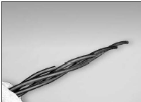
Для правильного надевания изоляционного чулка на жгут СИП необходимо предварительно обрезать жилы провода, причем каждая следующая с конца провода жила обрезается короче предыдущей, примерно на 10 см.
