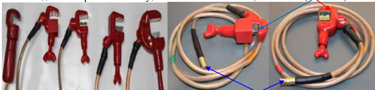
С другой стороны, на шунтирующих проводах закреплены **наконечники** для установки и фиксации проводов в винтовых зажимах на корпусе шунта.
