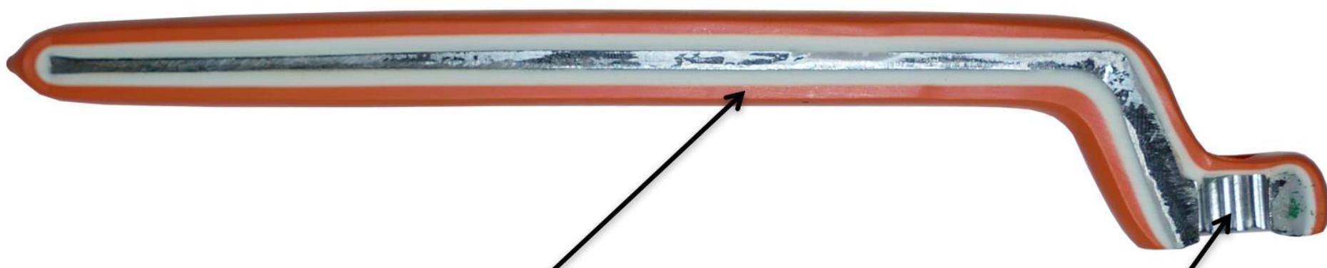
Два слоя изоляционного покрытия
