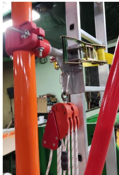
Траверса изоляционная 13128 Сектор Энерго для фиксации и подъема проводов на ВЛ-0.4кВ. Используется во время замены металлоконструкций и изоляторов при ПРПН
