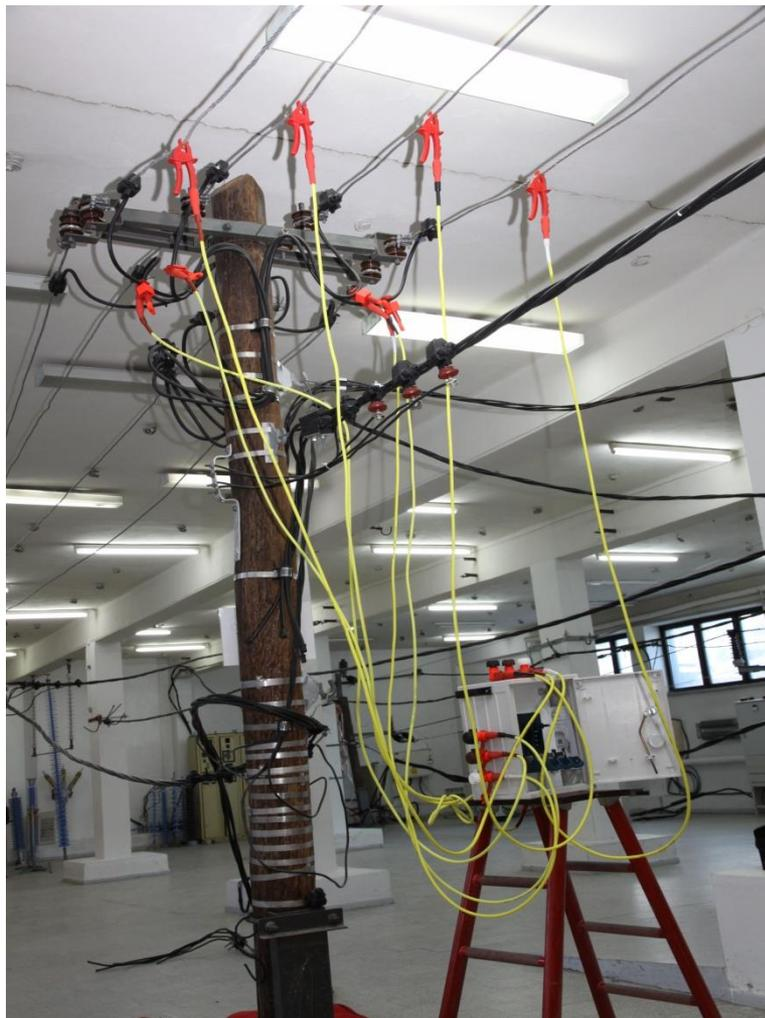
Шунт для ВЛ-0.4кВ (провода АС-СИП)
