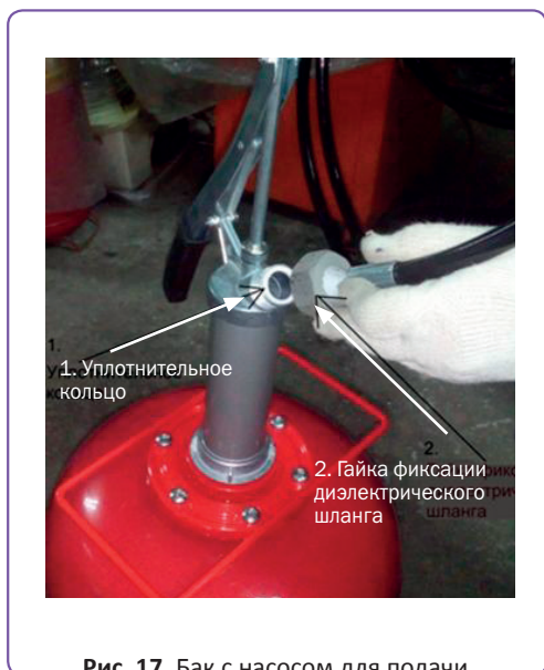
Рис. 17. Бак с насосом для подачи трансформаторного масла. Входит в комплект SE-7
