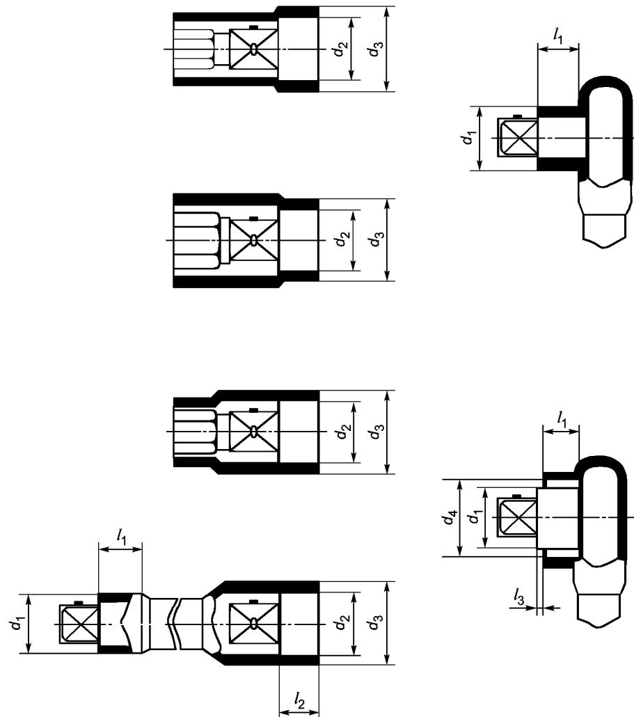
Рисунок 2 — Описание изоляционного перекрывающего элемента и различных конфигураций сборок для сборных инструментов с присоединительным квадратом
