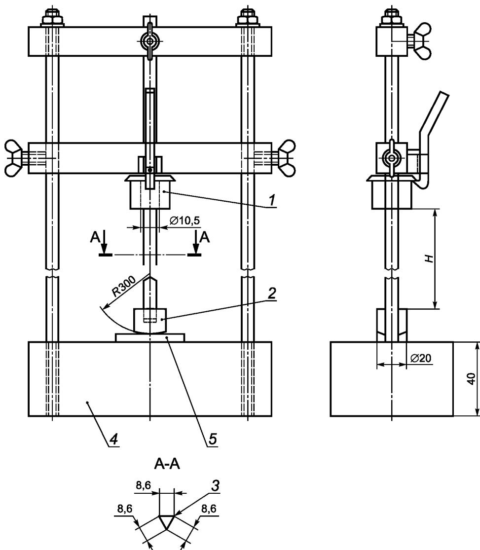
$H$  — высота падения; 1 — молоток; 2 — стальная промежуточная деталь массой 0,1 кг; 3 — слегка закругленные грани; 4 — стальная часть массой 10 кг; 5 — испытуемый образец
