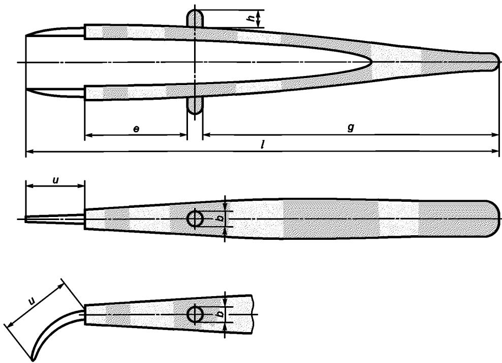
*l* — общая длина пинцета; *g* — длина рукоятки (поверхности захвата); *b* — ширина защитного упора; *h* — высота защитного упора; *e* — изолированная или изолирующая часть рукоятки между защитным упором и рабочей головкой; *u* — рабочая головка (изолированная или неизолированная)
