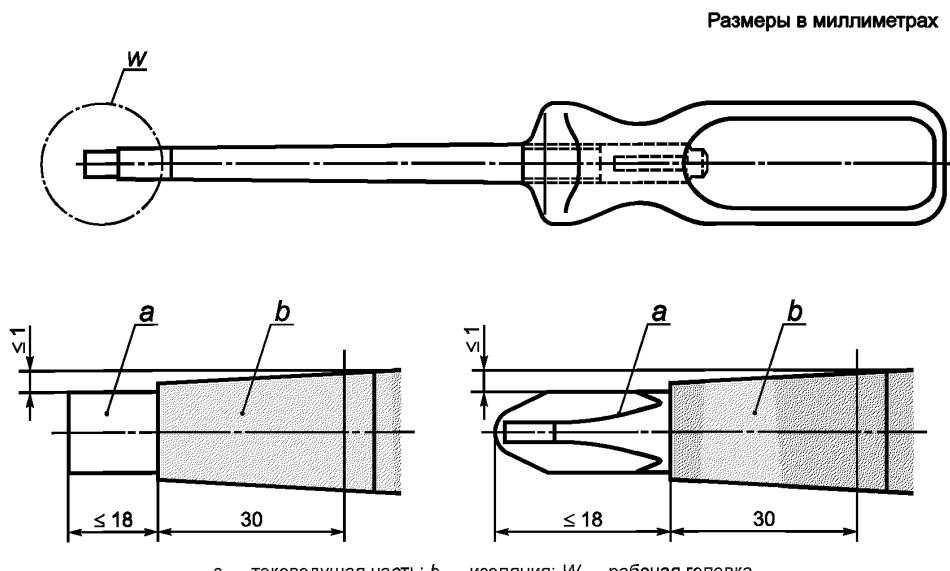
*a* — токоведущая часть; *b* — изоляция; *W* — рабочая головка
