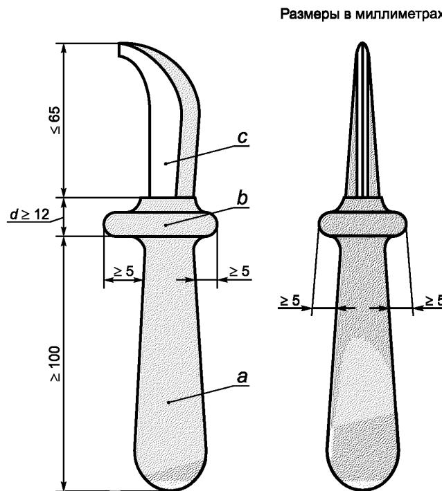
*a* — изоляция; *b* — защитный упор; *c* — режущее лезвие (неизолированное);
