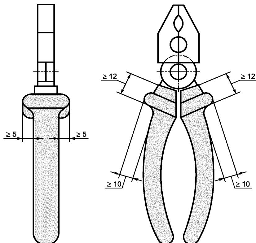
Рисунок 8 — Изоляция плоскогубцев
