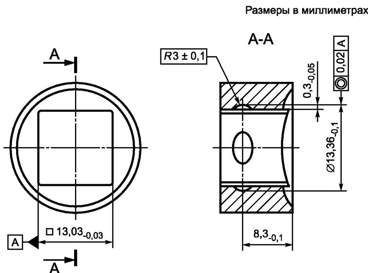
Рисунок 25б — Максимальный имитатор
