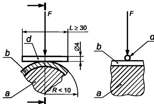
Рисунок 20б — Радиус в контрольной точке инструмента  $<10$  мм
