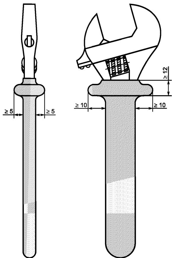
Рисунок 6 — Изолированный или гибридный разводной гаечный ключ
