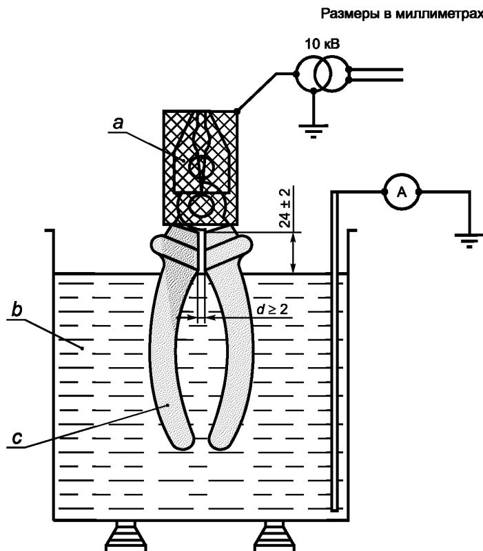
а — токоведущая часть; б — сосуд с водопроводной водой; в — изолированная или изолирующая часть инструмента;
