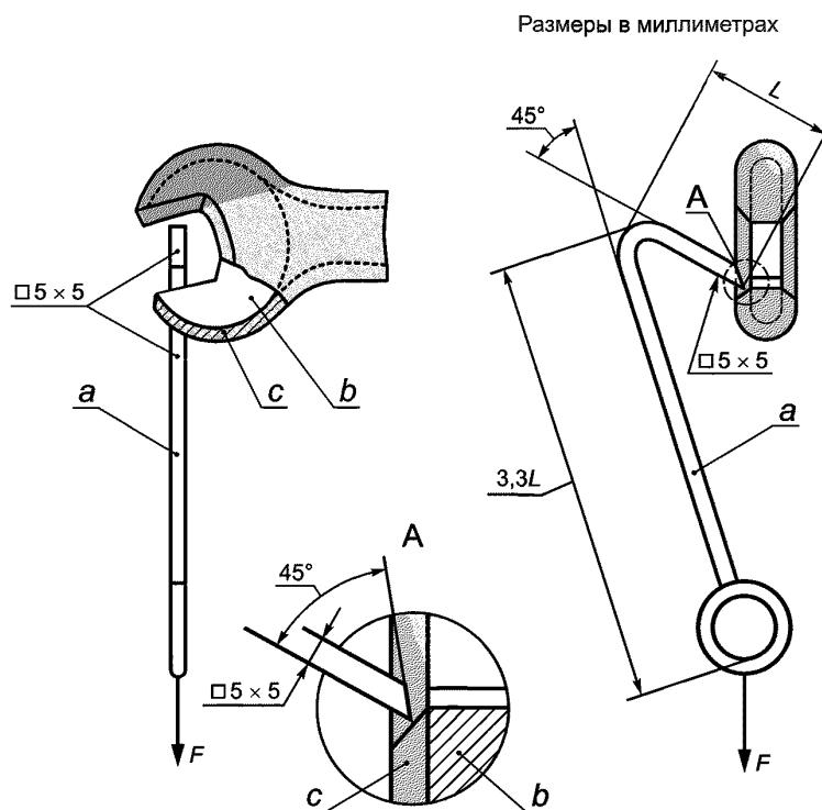
$a$  — крюк (длина плеча зависит от размера инструмента);  $b$  — токопроводящая часть с покрытием из изоляционного материала;
