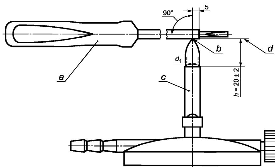
*a* — испытуемый образец; *b* — кончик пламени; *c* — горелка; *d* — горизонтальная опорная линия; *d*<sub>1</sub> — внутренний диаметр сопла горелки; *h* — высота пламени газовой горелки
