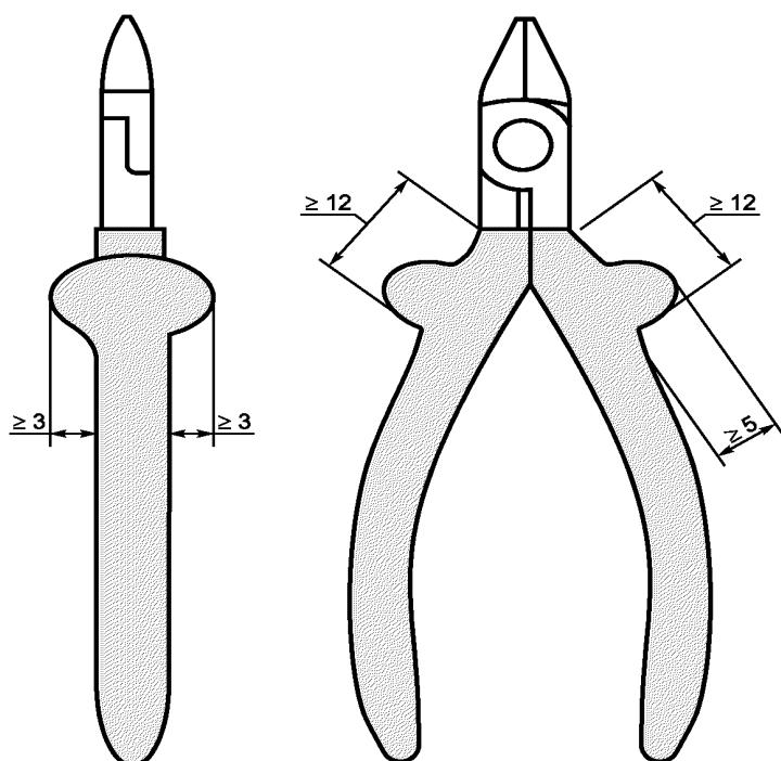
Рисунок 11 — Изоляции типичных плоскогубцов и кусачек для электроники
