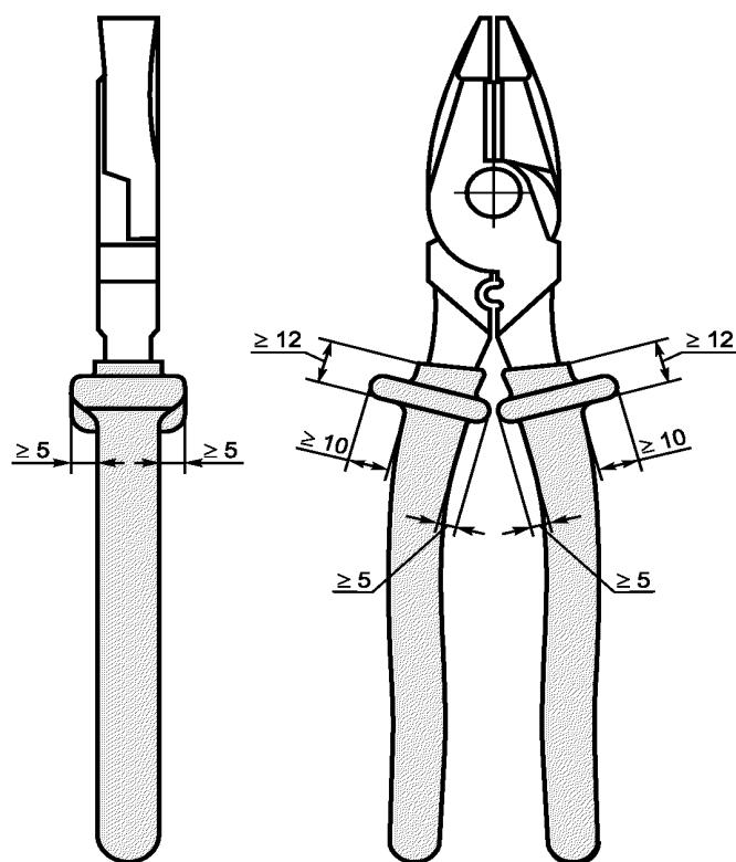
Рисунок 10 — Изоляция плоскогубцов с дополнительной функциональной поверхностью ниже оси шарнира
