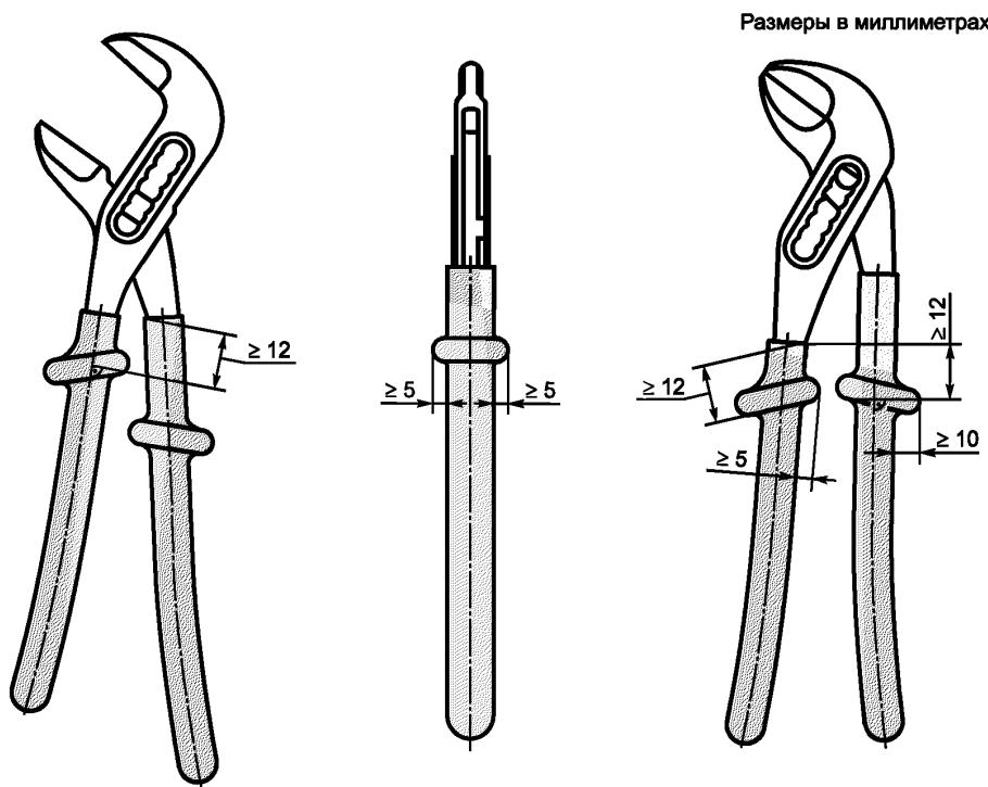
Рисунок 9 — Изоляция регулируемых плоскогубцов
